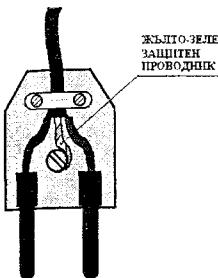
Жълто-зеленият проводник винаги трябва да се присъедини към защитната (нетоководяща) клема на щепсела или контакта. При контактите, захранени с двупроводникови линии, нулевият проводник, без да се прекъсва, трябва да се присъедини към защитната клема.
