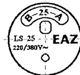
Този надпис показва, че апаратът за защита е предназначен за работа в уредби с напрежение 220/380 V и има номинален ток на изключване 25 A
